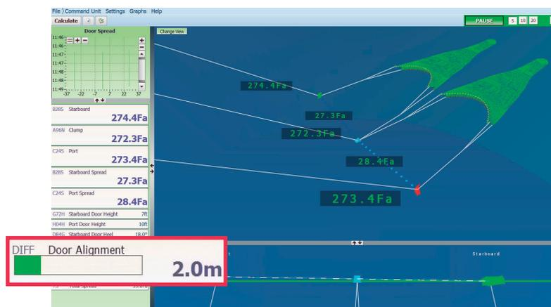
**Датчик сцепки позволяет скорректировать длину среднего ваера для выравнивания сцепки относительно траловых досок, что гарантирует высокую эффективность работы трала.**
