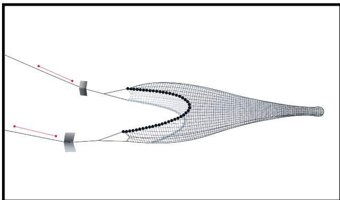
Значительная экономия топлива достигается путем выбора скорости траления для обеспечения оптимального горизонтального раскрытия трала. Например, превышение скорости траления при подводном течении всего на 0,1 узла может привести к избыточности горизонтального раскрытия на 10 м.
