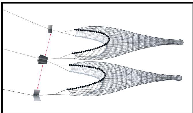
Для двойного или тройного трала измеряется раскрытие для КАЖДОГО трала. Это гарантирует возможность обеспечения одинакового раскрытия КАЖДОГО трала.
